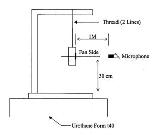
1 METER FROM MICROPHONE TO FAN INTAKE
